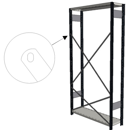
9. Hyllyn takatuet kiinnitetään M6x 12 ruuvein. Huomioi tukien soikean reiän asento. Takatukien sijainti on esitetty viimeisellä sivulla. Kaksipuoleisen hyllyn takatuenta ks. kuva 14.
